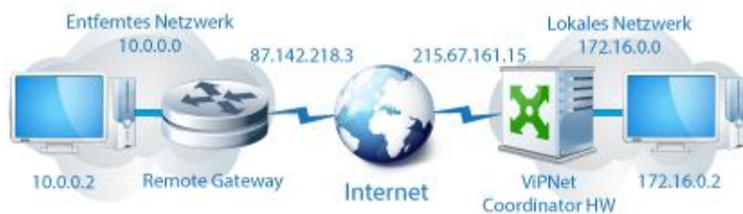
Abbildung 2: Aufbau von Verbindungen über das IPsec-Protokoll
